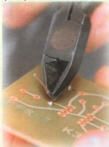
Figura 6.19. Corte de los terminales sobrantes
